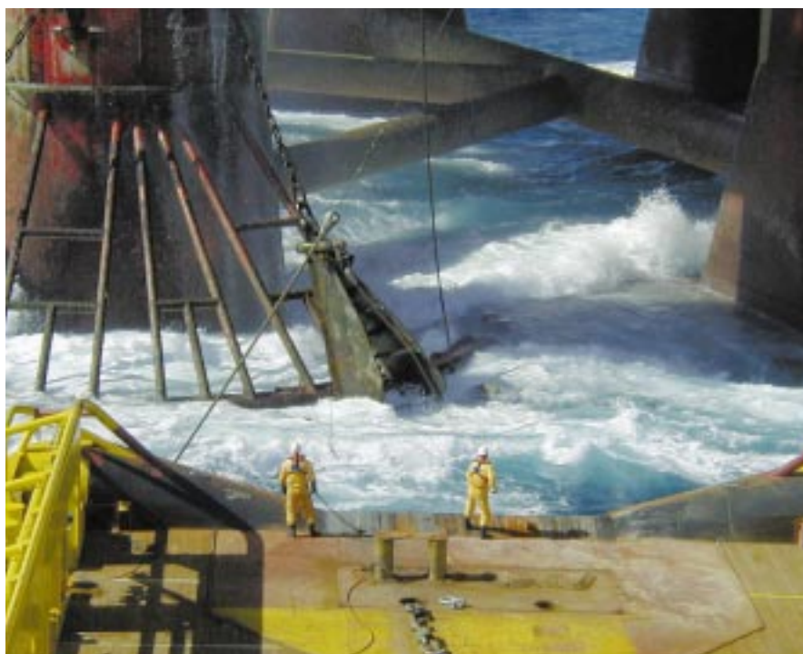
Tor Viking, på uppdrag väst om Shetland, närmar sig en rigg för att ansluta "the pennant wire", vajern som ankarhanteringsfartyget håller och placerar ut riggens ankare med.
