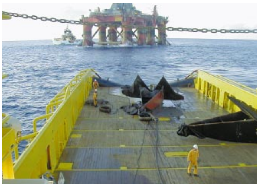
I ett och samma uppdrag inom offshore kan AHTS-fartygen sköta bogsering, positionering av riggen och upplacering av ankare. Ofta ingår även supplyverksamhet där förnödenheter körs ut till eller mellan riggar.
