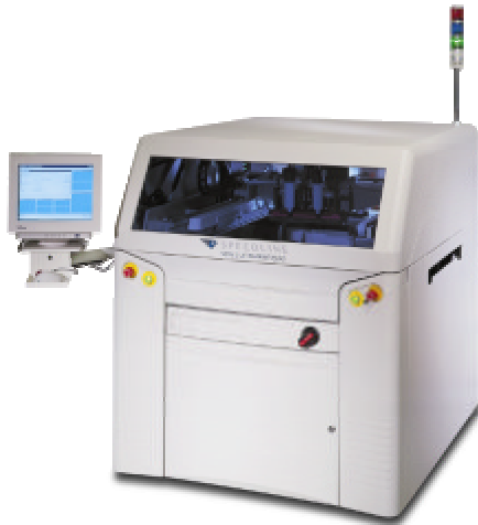
Screenprinter som del produktionslina för elektronik
